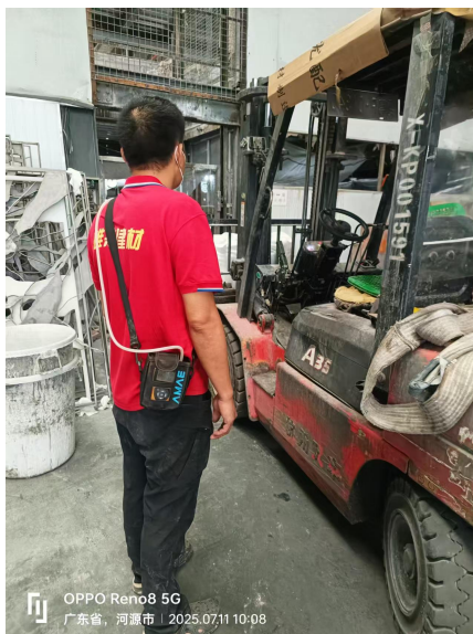
现场个体粉尘采样
