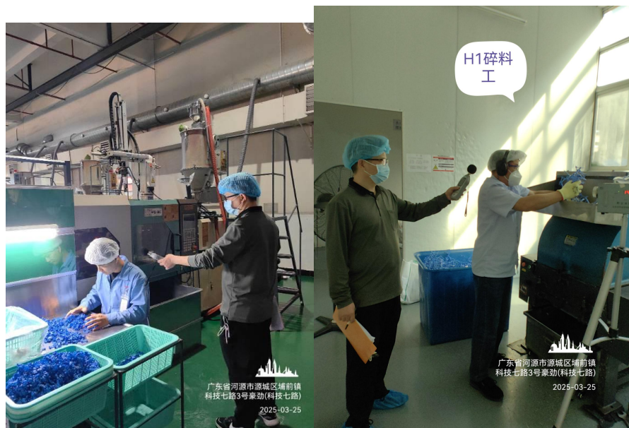
现场定点噪声测量
