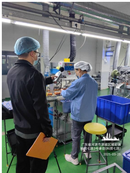
现场定点噪声测量
