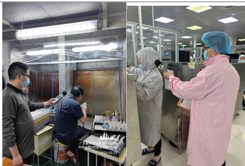
现场定点噪声测量
