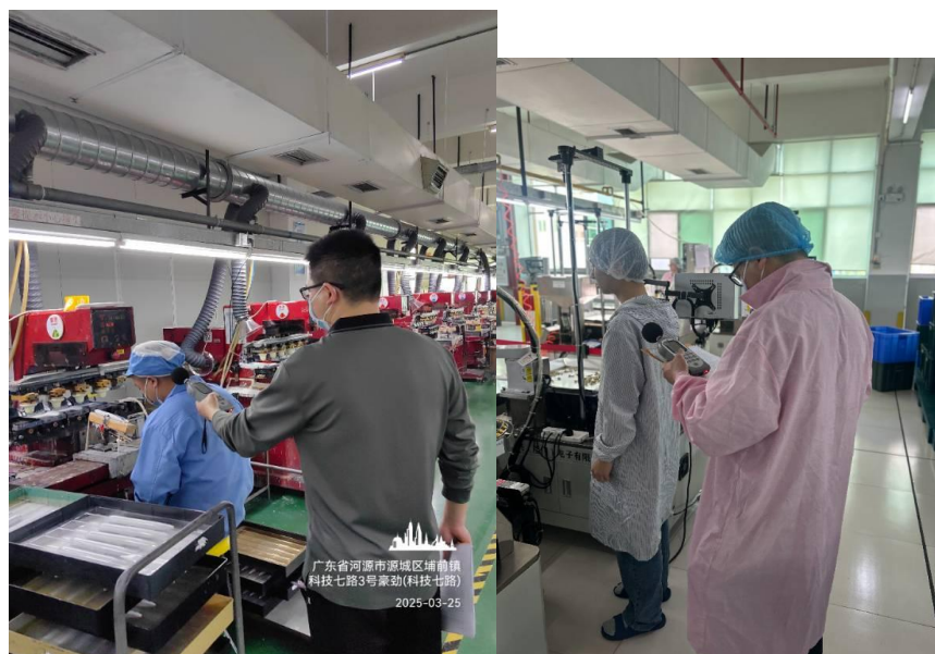
现场定点噪声测量
