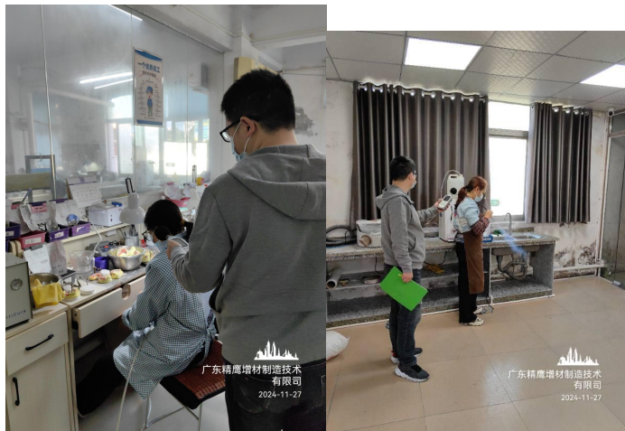
现场定点噪声测量
