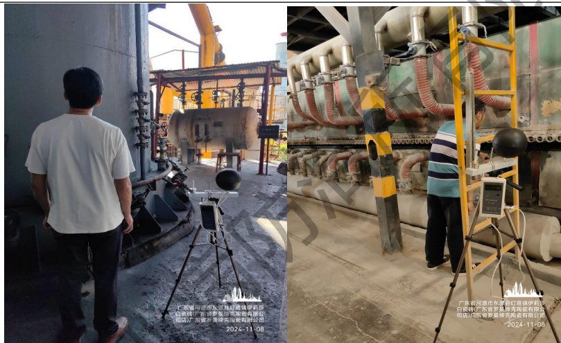
现场定点高温测量
