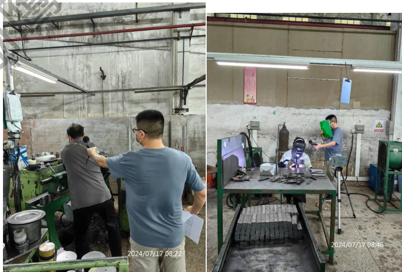
现场定点噪声测量
