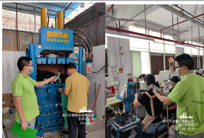
现场定点噪声测量
