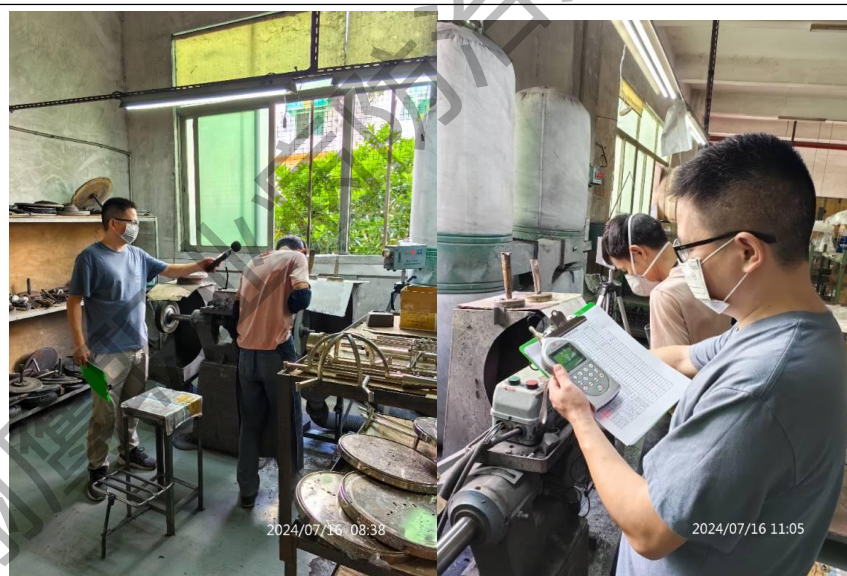
现场定点噪声测量
