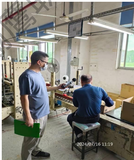
现场定点噪声测量
